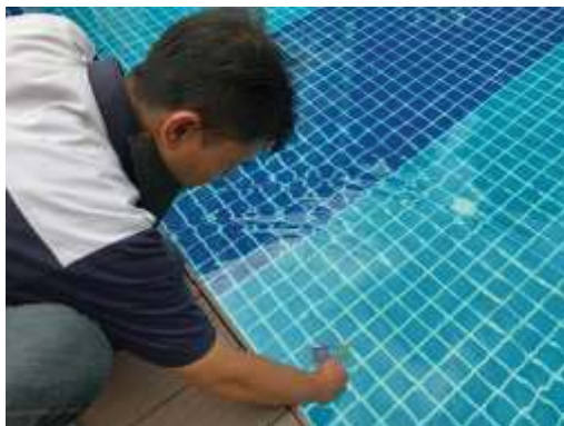
ภาพที่ 3.5.3-1 การตรวจวัด pH และ \text{Cl}_2 สระว่ายน้ำ
